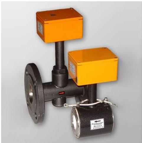
Электромагнитный счетчик-расходомер КСР-01/-02/-03, Ду 10...250мм, предназначен для измерения объема, объемного расхода и избыточного давления воды, а также других жидкостей с удельной электропроводностью не менее  $2 \times 10^{-3}$  См/м, в наполненных напорных трубопроводах для технологических целей и учетно-расчетных операций.
